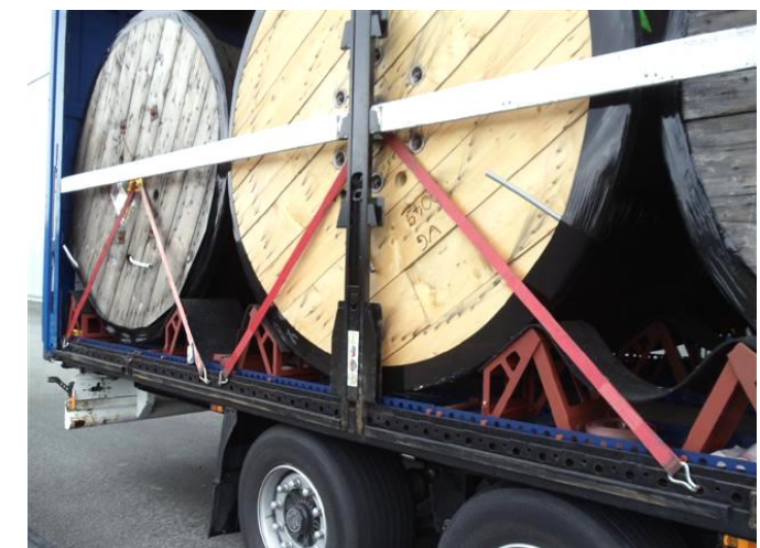
Das „GWS® FlexSis 280 PLUS“ Rollensicherungssystem – schnell, einfach und sicher!
