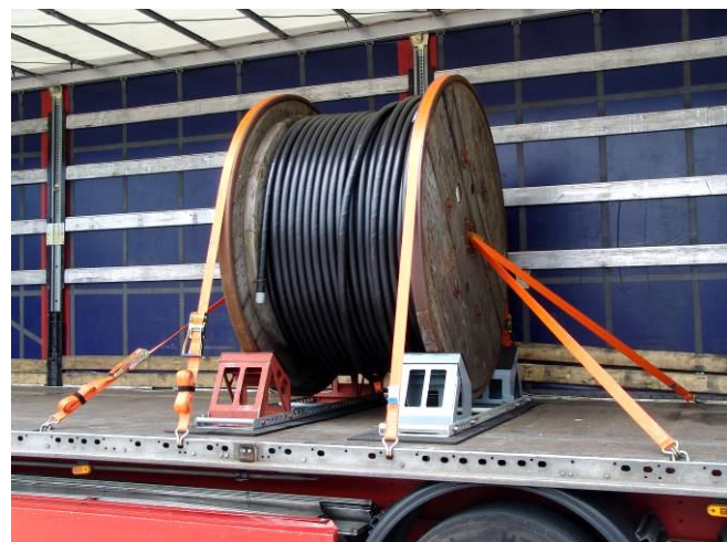
Der richtige Einsatz des „GWS® FlexSis 280 PLUS“ zur Sicherung einer Kabeltrommel.
